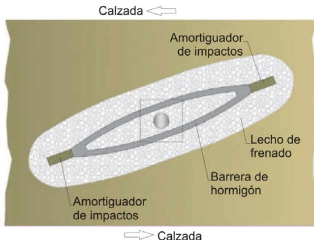
Protección alternativa de una pila. Planta
